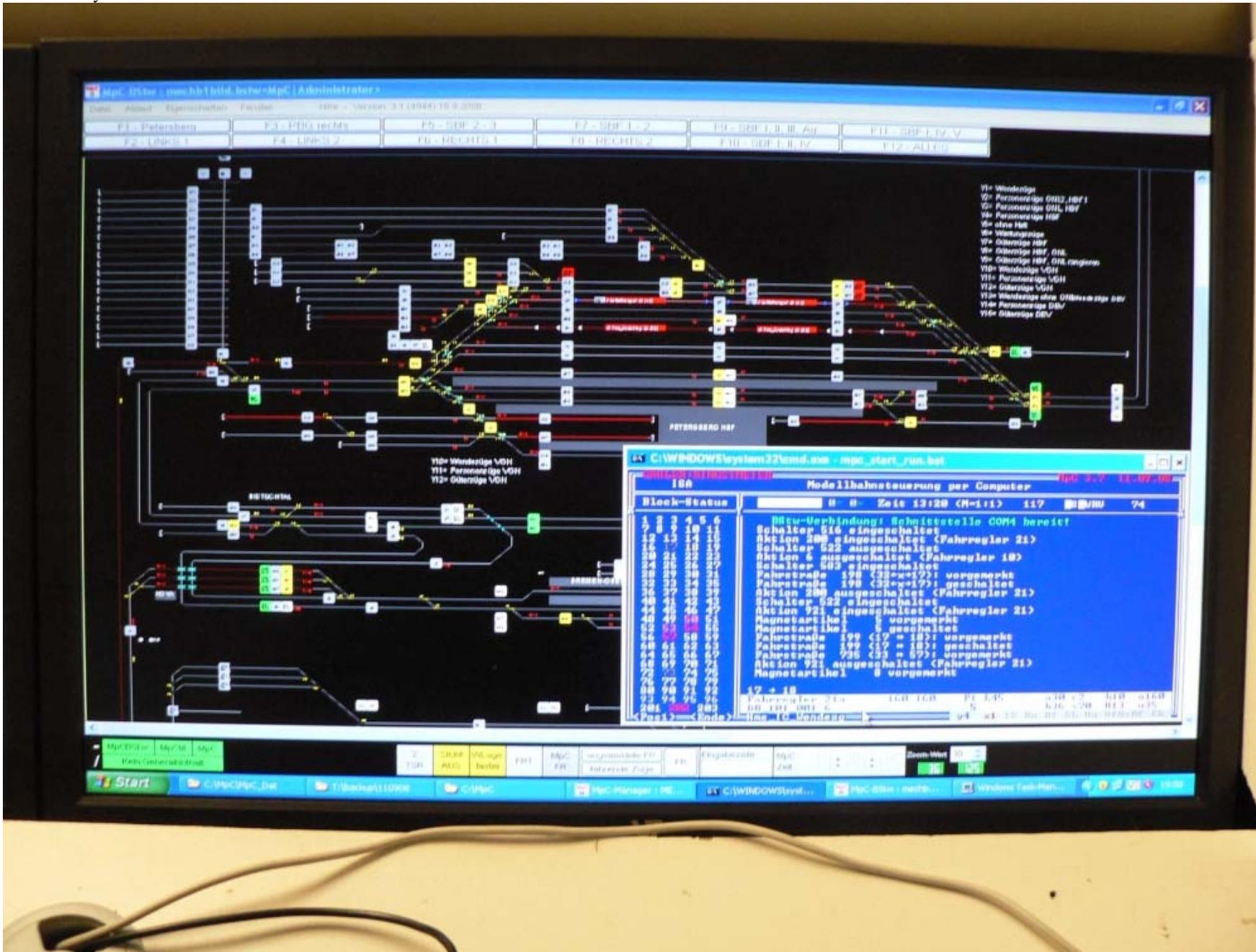
Abbildung 11 : Windows XP-Computer mit MpC-Steuerung, -Manager, -BStw und angeschlossener MpC-Hardware
